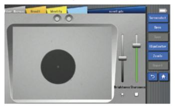
Der Faserendtester (Peripheriegerät erforderlich) wird hauptsächlich zum Testen der Sauberkeit und Ebenheit der Faserendfläche verwendet.
