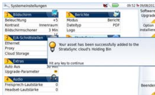
Abb. 29 Erstmalige Synchronisation mit Meldung zur Aufnahme der Plattform 2000
