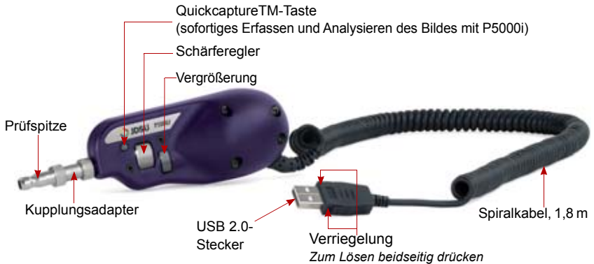
Abb. 16 Bestandteile des Mikroskops P5000i
