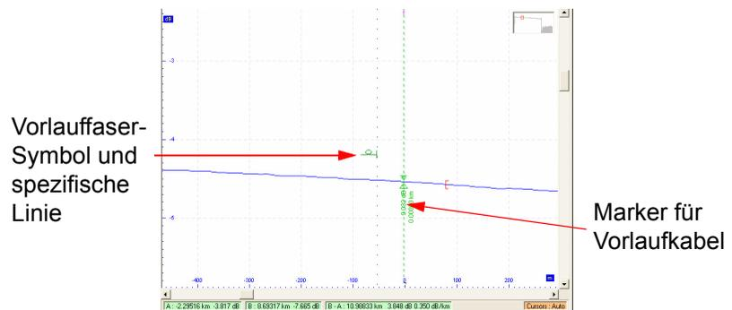
**Abb. 39** Ursprüngliche Position des Vorlaufkabels
