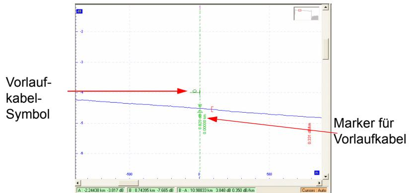
**Abb. 38** Anzeige des Vorlaufkabels auf der Kurve
