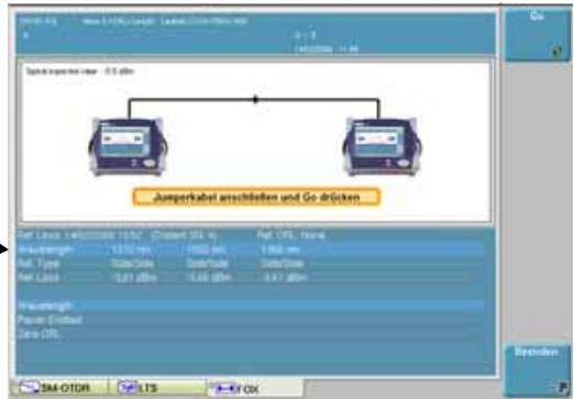
Abb. 86 Nebeneinander-Referenzmessung (hier mit Geräten der Serie 8000)
