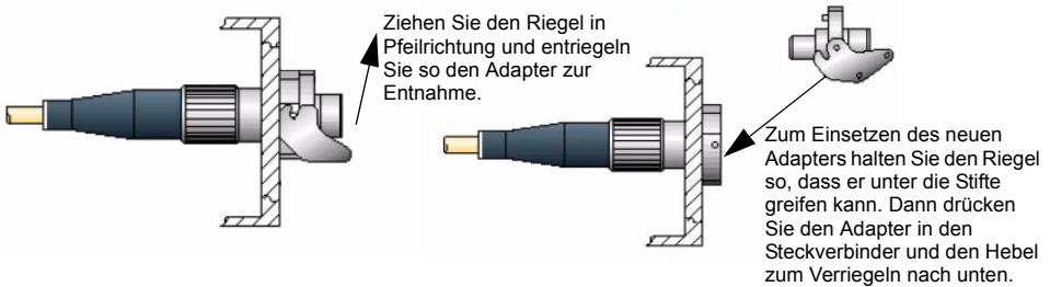
Abb. 13 Ausbau und Einbau eines Adapters
