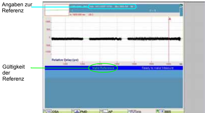
Abb. 74 Beispiel einer korrekten Referenzmessung mit angezeigten Messpunkten
