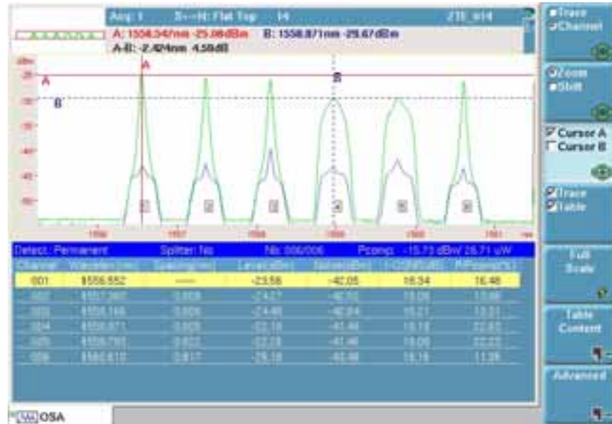
Abb. 52 Ergebniskurve einer I-OSNR-Messung
