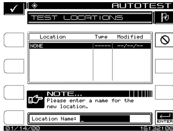
Abb. 13–25 Benennen eines Testortes
