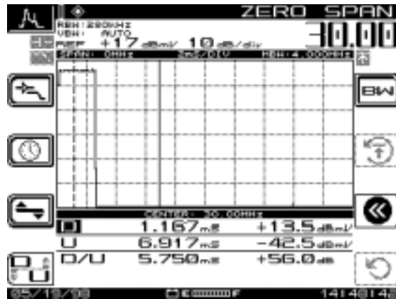
Abb. 5-5 Zeitsignal ohne Einstrahlung in der Nullspanne
